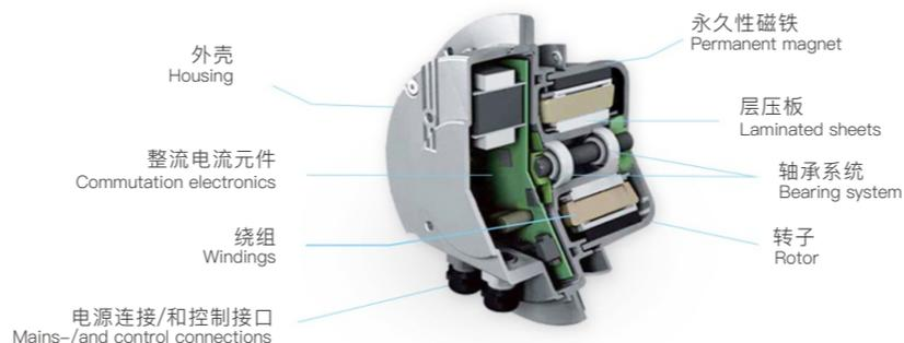
外转子EC直流无刷变频风机，绿色、节能、省电。
